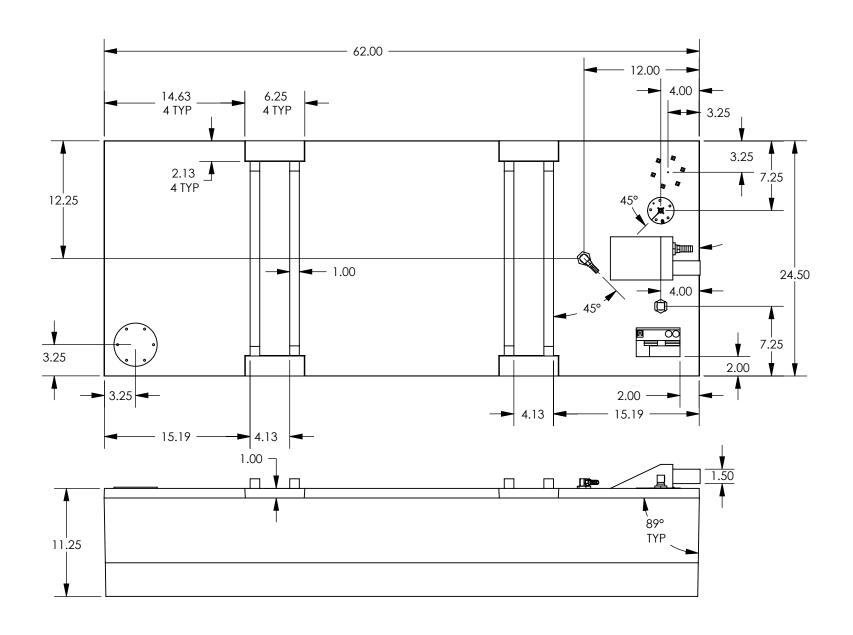
NOTE: DOGHOUSE IS 6.50 LONG, 4.50 WIDE, AND 2.50 TALL W/ A 1.25 TOP FLAT RIBS ARE 1.00 TALL, 1.00 WIDE, AND BEVELED 45° AT EACH END. FILL IS  $\emptyset$ 1.50 X 2.75
